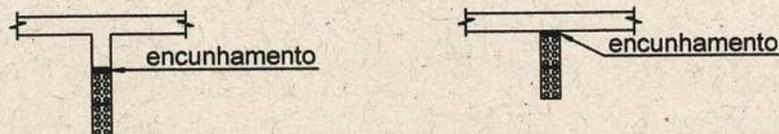
Todas as paredes dos diversos pavtos deverão ser encunhadas na laje do pavto imediatamente superior.
